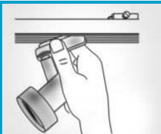
Los focos que se insertan en el riel se pueden deslizar a lo largo de él y situarse en cualquier posición; se introducen al bies y, a continuación, se abaten las patas de fijación
