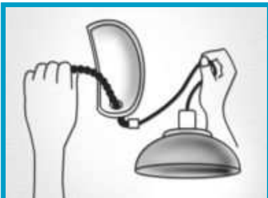
Para reemplazar el cableado eléctrico de una lámpara de formas caprichosas resulta útil recurrir a una cadenita de bolas
