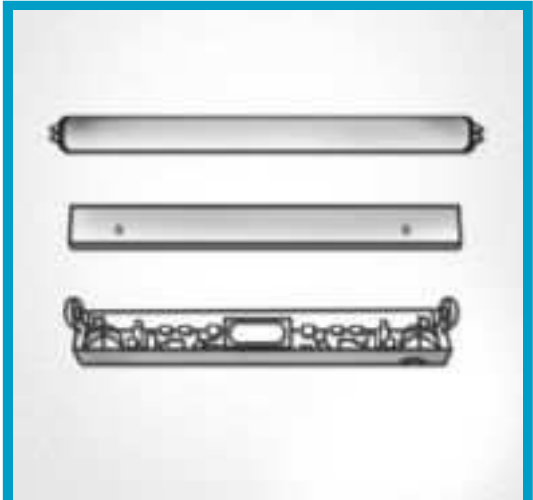
Para instalar un tubo fluorescente, pase los conductores y conecte los terminales a los bornes
