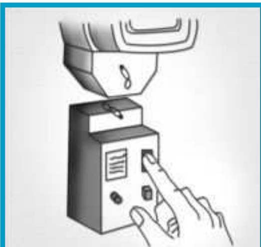
Antes de trabajar, desconecte el interruptor general
